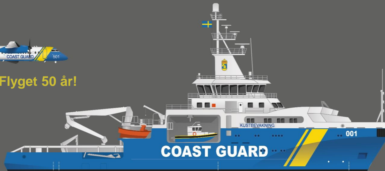
KBV 001-serien Längd: 81,2 m Bredd: 16,2 m Djupgående: 5 m Displacement: 3 760 ton Antal fartyg: 3
