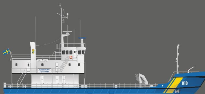
KBV 010 Längd: 46,1 m Bredd: 8,6 m Djupgående: 3,7 m Displacement: 430 ton Antal fartyg: 1
